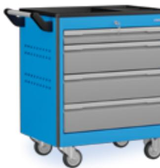
Инструментальная тележка с 4 выдвижными ящиками. Размеры: 795x780x490 мм. Вес: 42,2 кг. Нагрузка: 220 кг. Цвет корпус - RAL5015, гладкое полуматовое покрытие ящики - RAL7037, гладкое, глянцевое покрытие, ручки ящиков RAL9006, гладкое, глянцевое покрытие.
